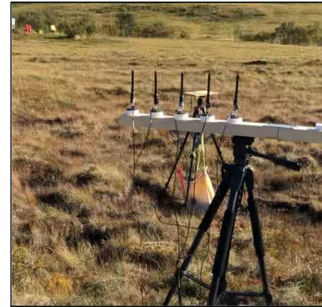
1st array: linear dipole antennas (ULA: Uniform Linear Array)
